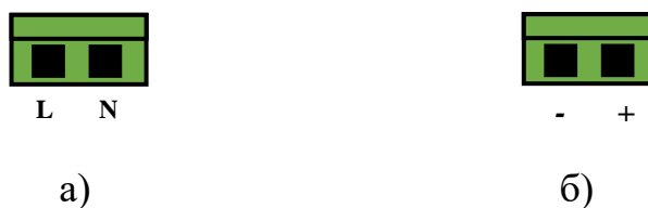
Рисунок 3 - Расположение контактов разъемов питания с соблюдением полярности: а) XP1 и XP2 для 220 В; б) XP3 и XP4 для 48 В
